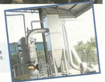
—HTD系統也需要使用蒸汽鍋爐，將蒸汽輸送至干燥爐。
