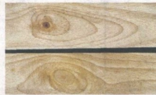
FOTO menunjukkan beza kualiti kayu yang dirawat dengan HTD (bawah) dengan kayu yang tidak dirawat.
