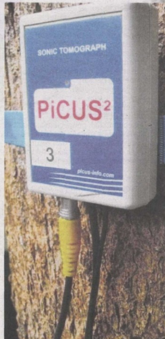
SENSOR yang dipasang pada bahagian batang pokok untuk mengesan gelombang bunyi yang dijana menggunakan electronic hammer .
