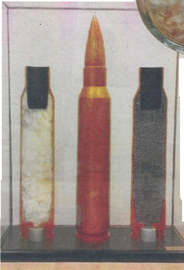
PERBANDINGAN antara serbuk peledak biasa dengan serbuk peledak yang menggunakan nitroselulosa.
