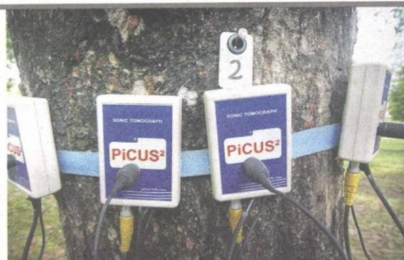
PICUS tomograph berteknologi sonar ini digunakan untuk mengesan ketumpatan batang pokok.
