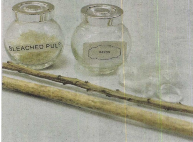
RAYON dihasilkan daripada pulpa selulosa yang terdapat dalam kenaf melalui proses pempulpaan dan pelunturan.
