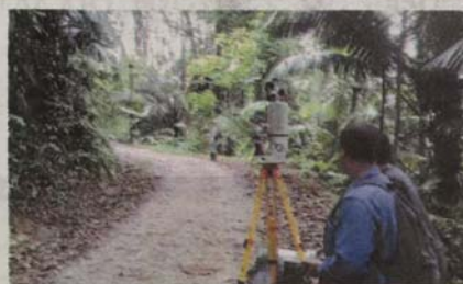
研究院公园使用地面激光扫描（Terrestrial Laser Scanning）技术，数据化地标记院内的每一棵树木。
